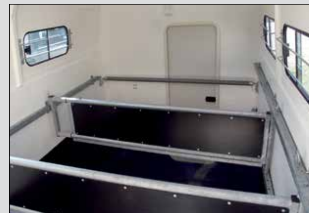
Telescopisch verstelbare tussenwanden, de paarden reizen in de voor hun meest comfortabele positie: achteruit
