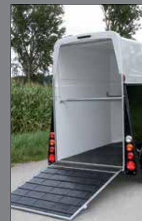
Rubber met geïntegreerde klimlatten (optie)
