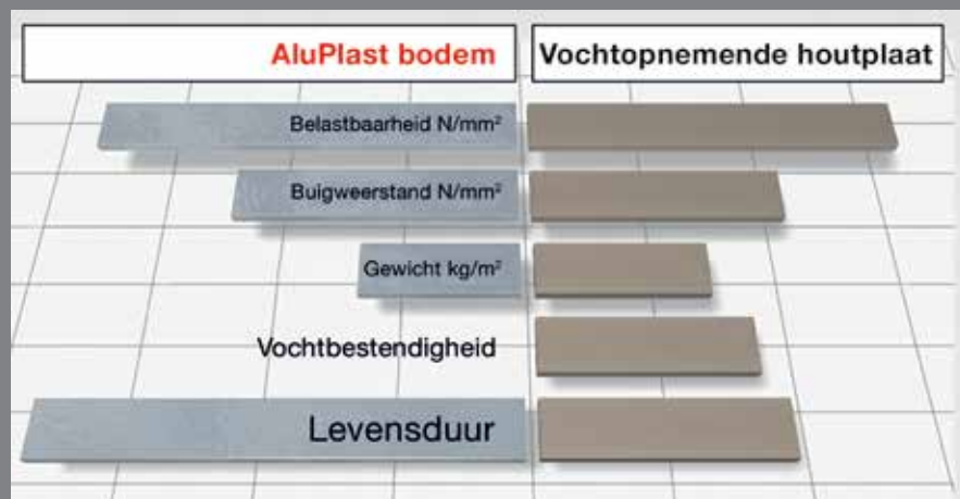
Vergelijking tussen de AluPlast® en houten bodem
