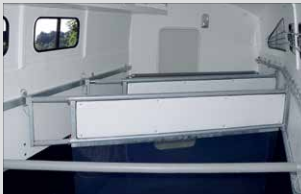
Telescopisch verstelbare tussenwand met flexibel kunststof (uitvoering 7, 8, 12)
