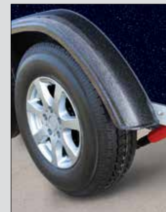
HALF-INSIDE-Systeem: De wielen gedeeltelijk geïntegreerd, een geringere totaalbreedte maar optimale wegligging.
