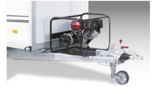
Stromerzeuger auf Deichsel
