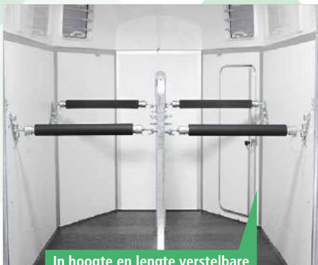
In hoogte en lengte verstelbare borst- en bilstangen
