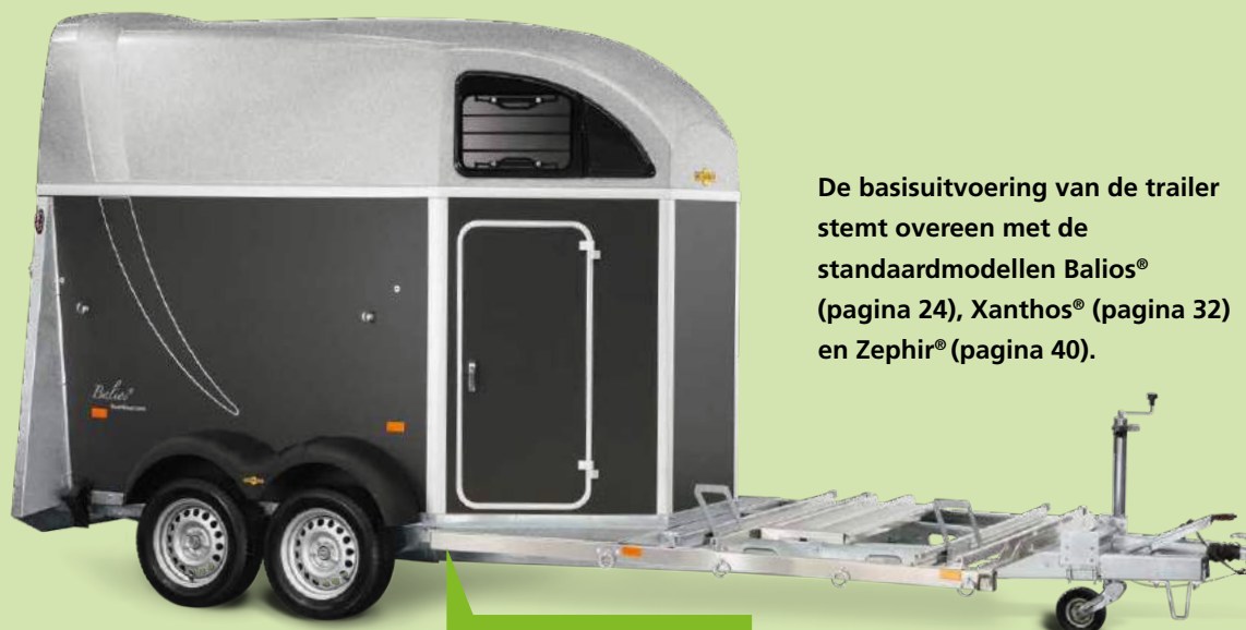
Balios® Koets met Plywood-polyester opbouw
